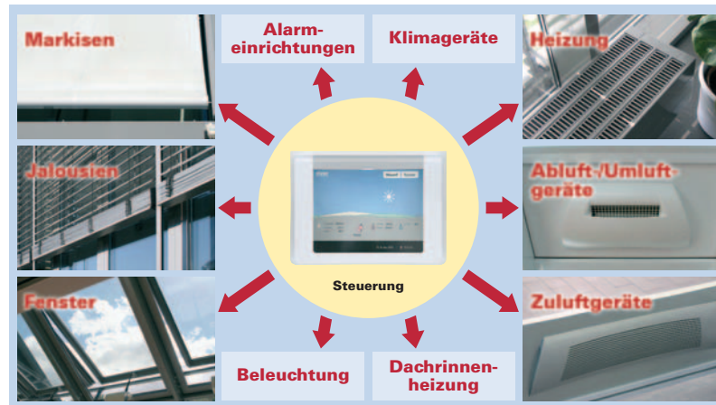
Die Wintergartensteuerung wertet die eingehenden Daten aus und regelt alle angeschlossenen Geräte entsprechend.
